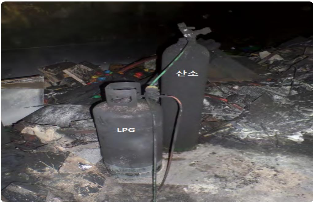
[사진 4] 산소 절단기와 연결된 산소 · LPG 모습
