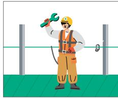
안전모 및 안전대를 착용한 후, 안전대 부착 설비에 안전대를 걸고 안전하게 작업합니다.
